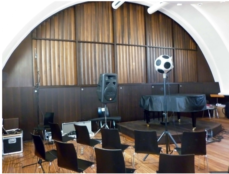
Abbildung 4.3.: Komplettes Messsetup im DCPS
